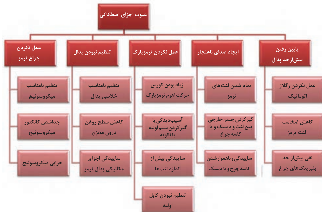
شکل ۲۳- عیوب اجزای اصطکاکی
