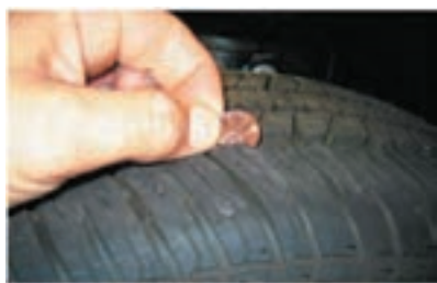
شکل ۱۷- نحوه اندازه گیری تقریبی شیار تایر
