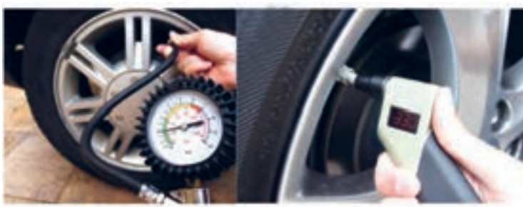
شکل ۲۱- شیوه بررسی و تنظیم فشار باد تایر
