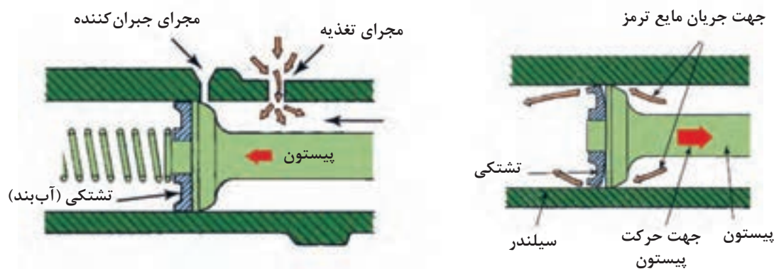
شکل ۱۲- عملکرد تشکی پیستون
