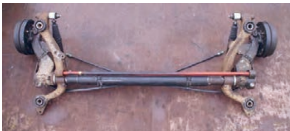
شکل ۴۳- مجموعه تعلیق عقب میله کشنده
