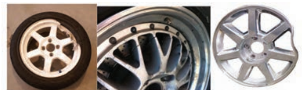
شکل ۳۵- بررسی ظاهری رینگ
