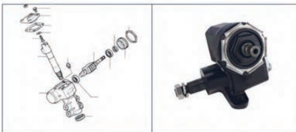
شکل ۲۹ - نوعی مکانیزم تنظیم لقی طولی مارپیچ فرمان
