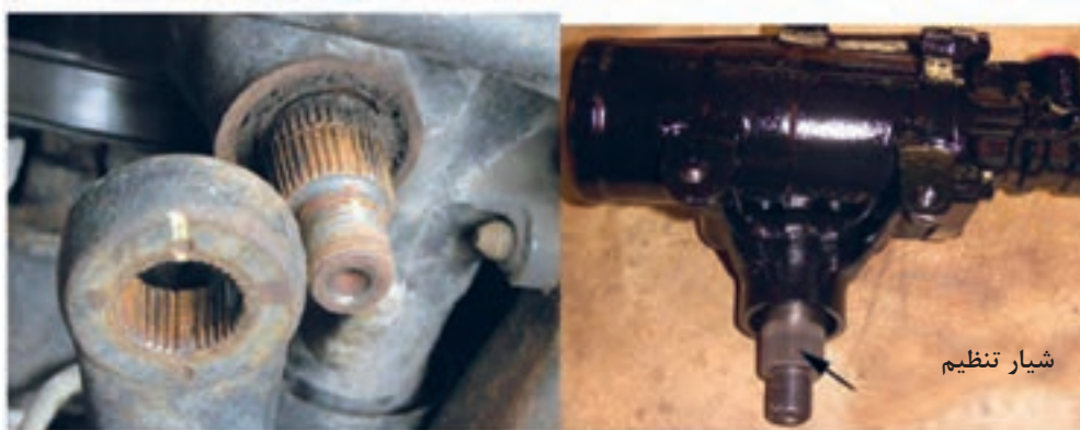
شکل ۳۲ - هزار خار محور خروجی جعبه فرمان
