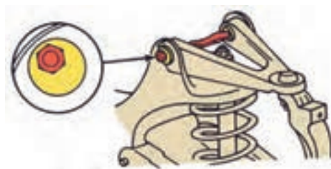
شکل ۳۹- مجموعه تعلیق طبق دار دویل و روش تنظیم زوایا
