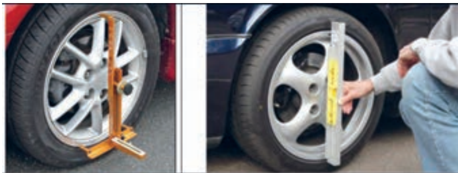
شکل ۴۲- ابزار مخصوص بررسی و تنظیم زوایای چرخ
