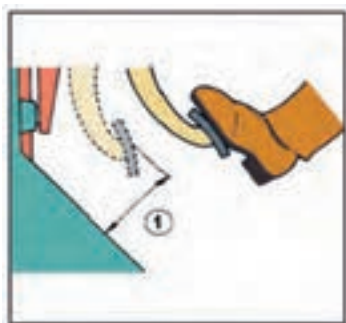
شکل ۱۶- بازدید فاصله پدال ترمز تا کف
