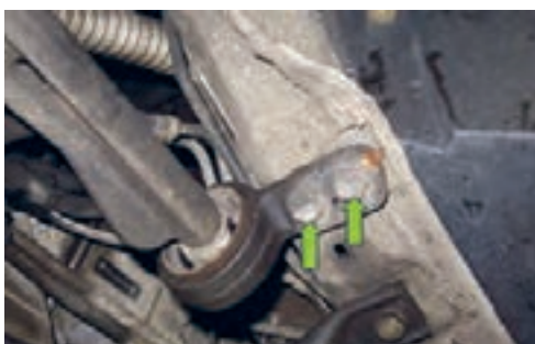
گشتاور سنجی اتصالات پیچ و مهره ای
