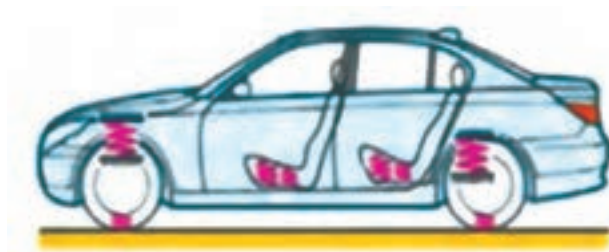
شکل ۱- سیستم تعلیق در خودرو سواری
