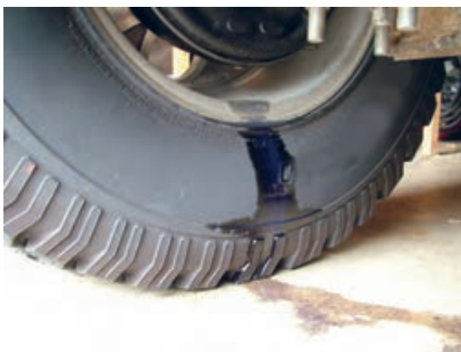
شکل ۴۱- وجود مایع اطراف چرخ عقب
