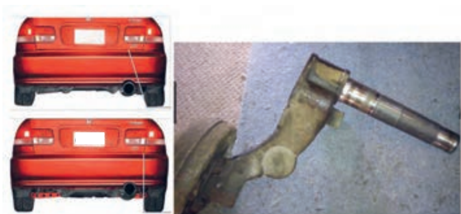
شکل ۴۵- خرابی بوش‌ها و تأثیر آن روی چرخ
